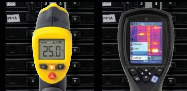
Pyromètre : mesure de température en un point
